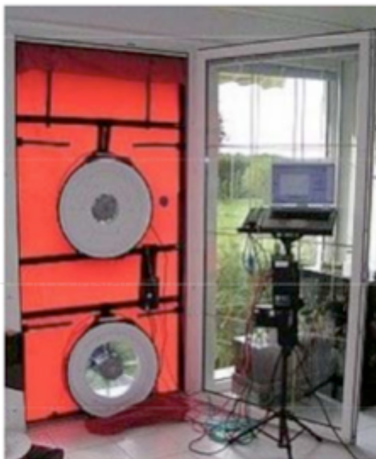
Porte soufflante ou «Blower Door»
